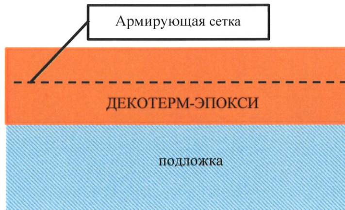
Рисунок 1. Установка армирующей сетки
